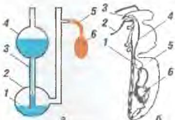
**Рис. 2. Прибор для определения вязкости жидкости и пищеварительная система пчелы: а — вискозиметр (1 — жидкость; 2, 4 — расширительная емкость; 3 — капилляр; 5 — резиновый шланг; 6 — резиновая груша); б — пищеварительная система пчелы (1 — медовый зобик; 2 — хоботок; 3 — глотка; 4 — пищевод; 5 — брошко; 6 — кишечник)**
