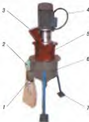
Рис. 1. Общий вид агрегата АИП-30: 1 — патрубок для отвода воскового сырья; 2 — пусковое устройство; 3 — загрузочная горловина; 4 — электродвигатель; 5 — измельчитель; 6 — циклон; 7 — выгрузной патрубок для гранул перги
