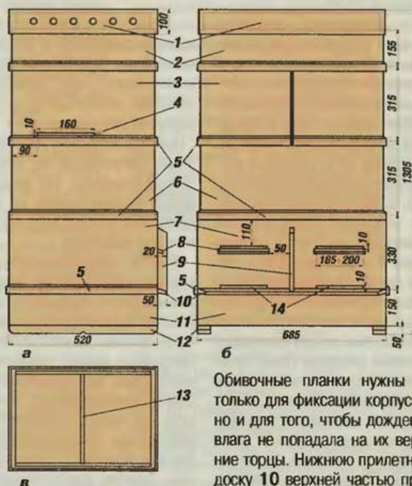
Рис. 2. Улей Озерова: а — вид сбоку; б — вид спереди; в — нижний корпус (вид сверху)
