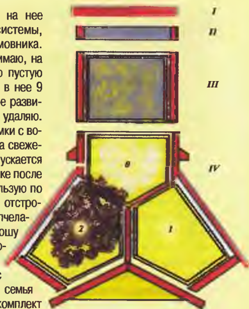
Рис. 1. Схема устройства улья: I — крыша; II — подкрышник; III — надставка; IV — расплодный блок с тремя секциями (0; 1; 2)
