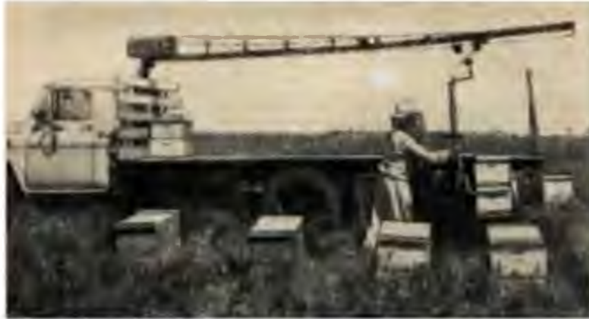
Рис. 90. Погрузчик ульев, смонтированный на раме грузового автомобиля, позволяет одному человеку грузить и разгружать ульи или снимать надставки с медом.
