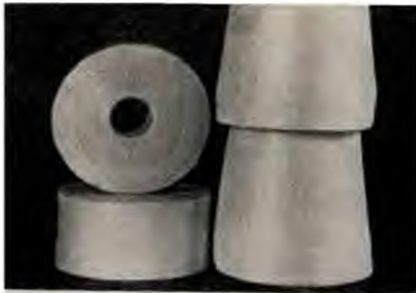
Рис. 68. Лепешки хорошо очищенного пчелиного воска расплавляют и отжимают под давлением на листовой машине в виде гибкой ленты чистого пчелиного воска, которую скручивают в рулон (как показано на рисунке) для удобства использования
