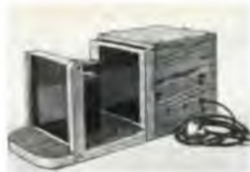
Рис. 110. Полярископ – прибор для оценки меда.
