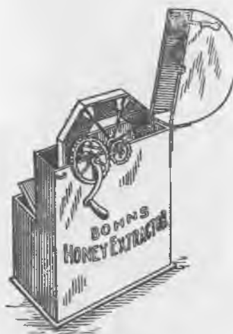
Рис. 9. Одна из первых медогонки, в которой соты вращались в вертикальной плоскости. Рисунок взят из американского журнала « Gleanings in Bee Culture » за ноябрь 1893 г.
