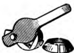
Рис. 6. Кран для выпуска меда с вырезом в виде буквы V, позволяющий регулировать силу струи.
