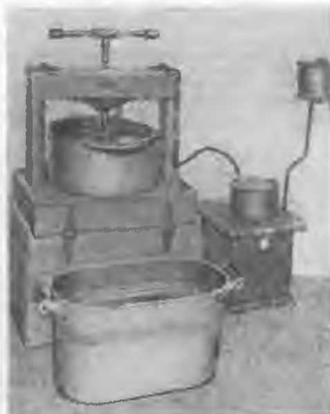
Рис. 5. После закручивания винта воск всплывает на поверхность воды. Время прессования не ограничено, так как вода подогревается струей пара из кипятыльника.
