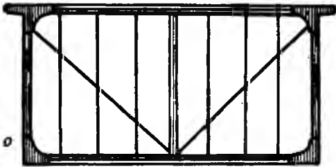
Рис. 9. Рамка с проволокой, впервые примененная А. И. Ругом в 1878 г. Тонкая верхняя планка укреплена согнутой жестяной пластинкой.
