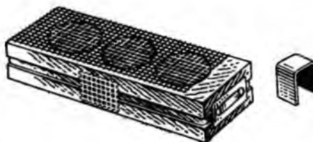
Рис. 4. Клеточка Бейтона с приспособлением Чантри. U-образная жестяная пластинка надвигается на отверстие.
