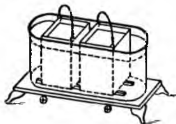
Рис. 1. Два 19-литровых бидона квадратной формы погружены без крышек в бак, заполненный водой. Под бидоны подложены деревянные планки, чтобы мед не подгорал. Под баком видны газовые горелки.
