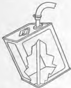
Рис. 3. По мере того как по шлангу откачивается мед, бидон начинает всплывать на поверхность воды. Наконечник шланга проскальзывает в один из углов бидона и таким образом извлекается весь мед.
