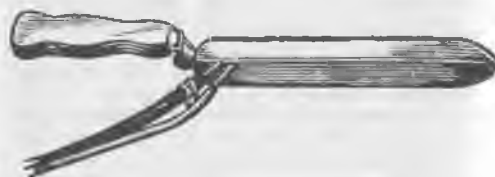
Рис. 3. Нагреваемый паром ручной нож для распечатывания сотов.
